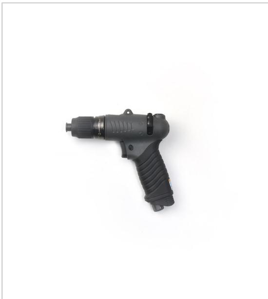
Pour petites et moyennes séries couple réglable par bague externe crantée embrayage à clabot visualisation des puissances par fenêtre carter composite léger et isolant poignée ergonomique inverseur droitier-gaucher échappement directionnel sur silencieux anneaux d'accrochage entrées d'air multiples adaptées au poste de travail capacité M3-M5.
