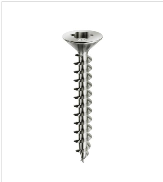
Vis Panelvit Filetage Total empreinte Torx TX, à revêtement Chromiting (résistance à la corrosion 5 fois supérieure au zingage blanc standard - Grade 4 de la norme NF EN 1670). Vis universelle lubrifiée indiquée pour le vissage sans pré-perçage dans : panneaux agglomérés mélaminés, bois, éléments de quincaillerie, tôles fines, matières plastiques et chevilles.
