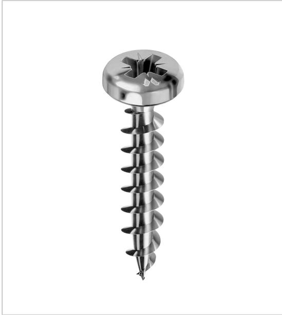
Vis à bois Panelvit tête ronde empreinte cruciforme (PZ) à Filetage Total. Traitement galvanique Chromiting qui protège la vis contre la corrosion et la rouille dans le temps (résistance à la corrosion en brouillard salin > 240h - Grade 4 norme NF EN 1670).
