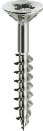
Vis Panelvit Tête Fraisée Partiellement Filetée empreinte cruciforme (PZ) - Traitement anticorrosion Chromiting (résistance à la corrosion 5 fois supérieure au zingage blanc). Vis conseillée pour fixer ensemble des éléments de grande épaisseur sans prépercer les parties à assembler.
