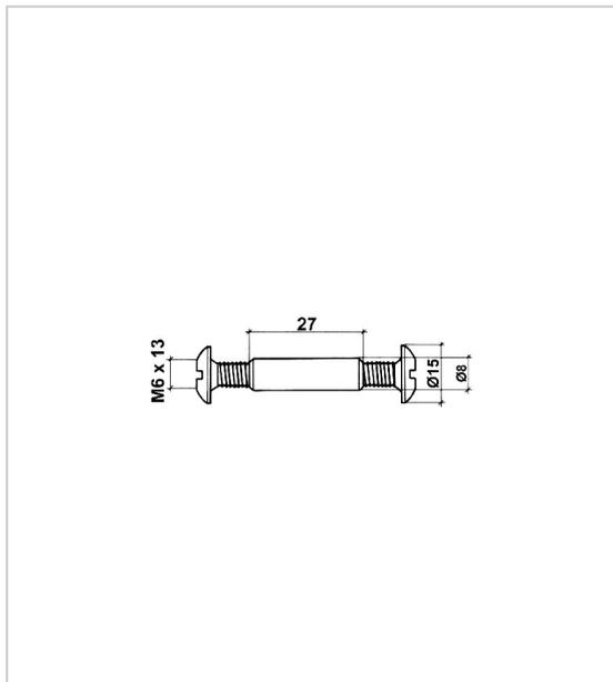
Vis de jonction avec vis M6x13 acier et corps zamac.
