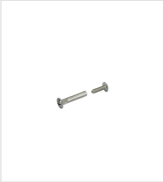
Raccord fin à forces d'assemblage élevées. Pour perçage de 5mm de diamètre . Les douilles d'assemblage ont une longueur de 27 et 35 mm. Le taraudage est décalé et permet de visser plus facilement la vis d'assemblage. Vis M4 x 15 mm
