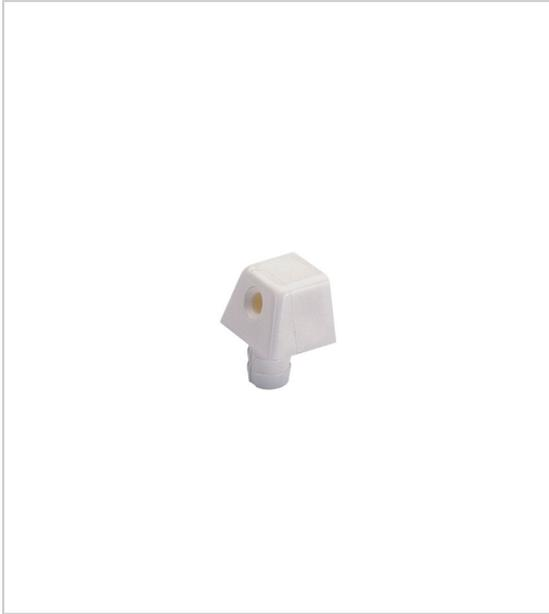
Ferrure d'assemblage trapézoïdale TZ 28 à enfoncer, longueur de tenon 10 mm plastique blanc Fixation vis à tête fraisée, diamètre 4 mm Possibilité de présenter le tournevis de biais pour resserrer.
