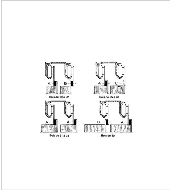
Rail de roulement double en aluminium.
