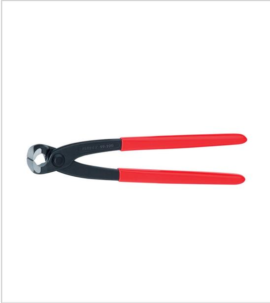
Acier à outils de qualité spéciale, forgé, trempé à l'huile en plusieurs phases pour lier le fer à béton armé tête polie. tranchants trempés, dureté d'environ 61 HRC les modèles 99 00 sont atramentisés noir, tête polie les modèles 99 01 disposent en plus de poignées gainées en plastique.
