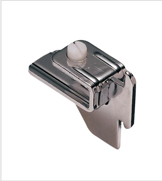
Taquet pince pour pose de tablette verre avec vis de serrage sur le dessus. Pose sur crémaillères au pas de 37mm.
