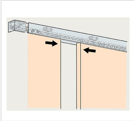
Mécanisme complémentaire qui permet l'ouverture ou la fermeture synchronisée de 2 portes posées sur le même rail simple.
