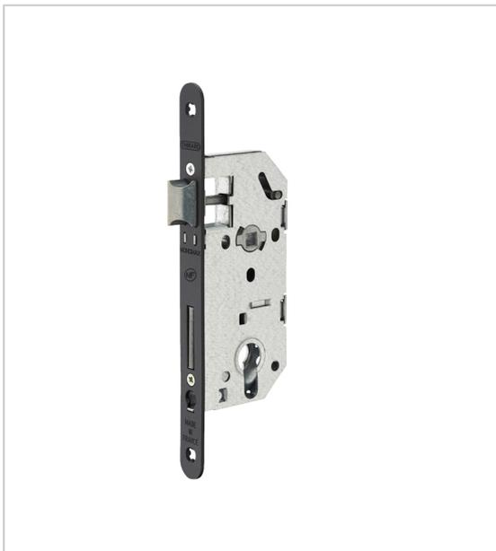
Coffre acier embouté galvanisé tête acier bouts ronds époxy noir granité demi-tour bi-pente alliage réversible sans démontage du coffre pêne acier galvanisé mécanisme à 2 tours pour menuiserie bois dimensions tête (L x l x é) : 230 x 20 x 2.5 mm livré sans gâche (références fabricant : 046102 ou 046100 pour bec de canne) garantie 10 ans.
