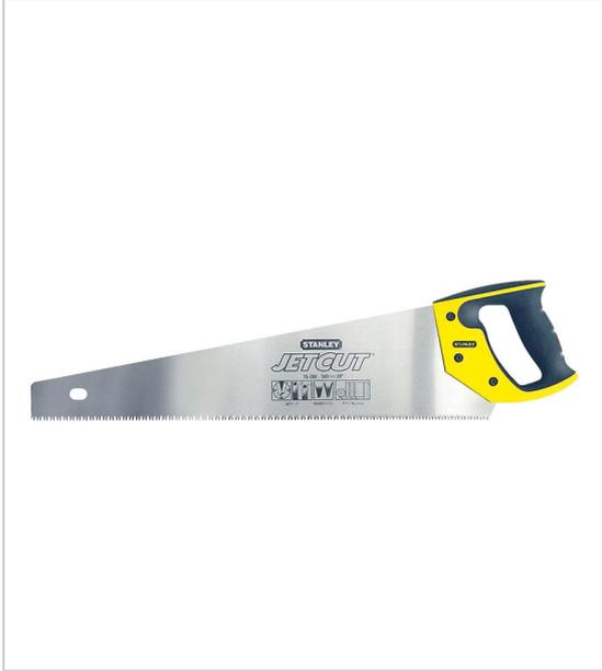
La denture a également été trempée par induction pour des performances et une durée de vie exceptionnelles. Poignée vissée à la lame pour une résistance ultime. Conçue en acier C75S de 0,85 mm, elle offre un minimum de flexion lors de la coupe pour plus de contrôle. La poignée comprend un guide de coupe à 45° et 90°.
