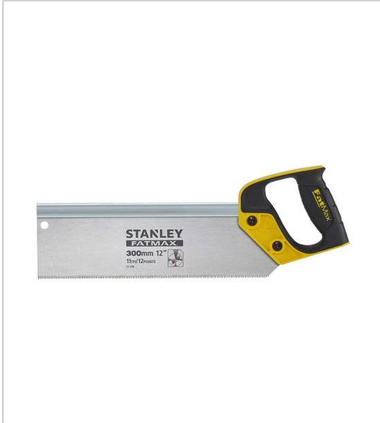
Idéal pour les travaux de finition denture JetCut 11 dents/pouce et denture universelle 13 dents/pouce traitement de denture HardPoint 2x avec avoyage alterné lame de 0,86 mm d'épaisseur pour plus précision de coupe dos renforcé pour plus de contrôle lors du sciage poignée bi-matière ergonomique fabrication française.
