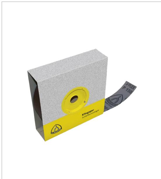
Support toile coton JF-toile abrasif corindon poudrage serré liant : résine synthétique adapté au travail des contours des pièces profilées découpe du rouleau propre et facile convient principalement au travaux sur acier inoxydable, acier, métaux non-ferreux, ou sur bois dimensions : 40 mm x 25 m.
