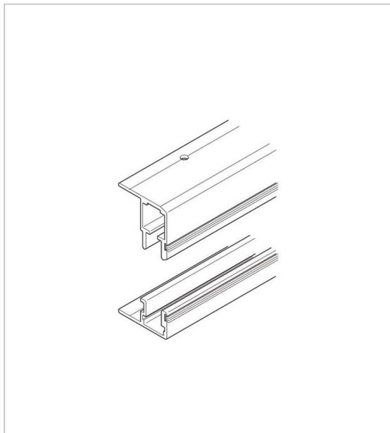
Rails de roulement et de guidage pour Multifold 30.
