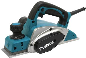
Réglage de la profondeur de coupe par pas de 0,1 mm pied de protection escamotable éjection des copeaux améliorée poignées caoutchoutées et antidérapantes palier de roulement en aluminium cordon d'alimentation de 2,5 m livré en coffret MAK-PAC avec calibre de réglage, clé à douille, raccord poussière.
