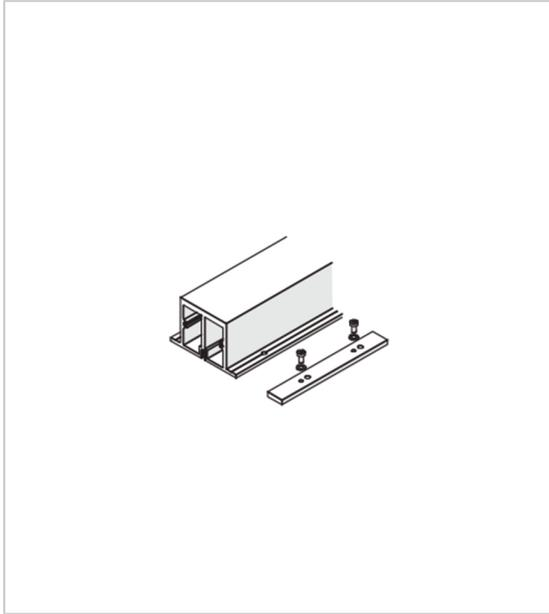
Profil de renforcement avec plaque de raccordement pour rail de roulement Folding Concepta.
