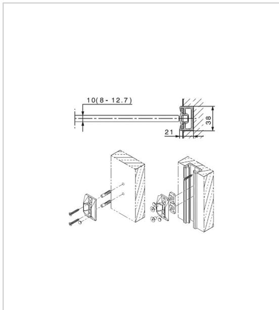
Raccordement optimal au mur pour portes tout-verre coulissantes avec chant de verre non protégé.
