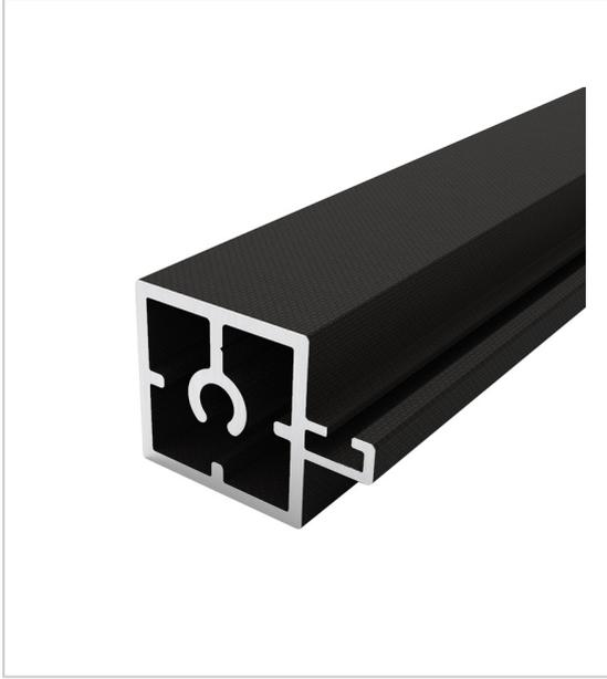
Profil aluminium en tube carré pour la conception de structures étagères diverses, doté d'un rebord sur le côté permettant la pose d'une étagère verre de 6-8mm dans la structure.
