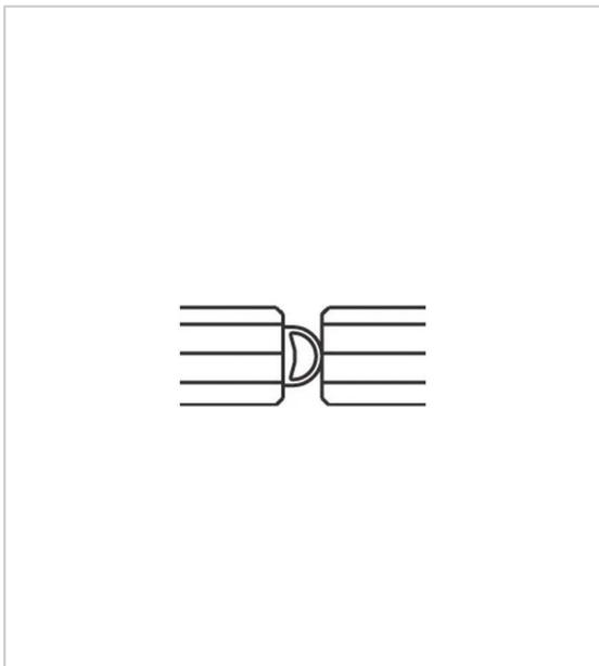
En caoutchouc, autocollant, translucide, pour épaisseur de verre 8/10 mm, distance de verre 4 mm.
