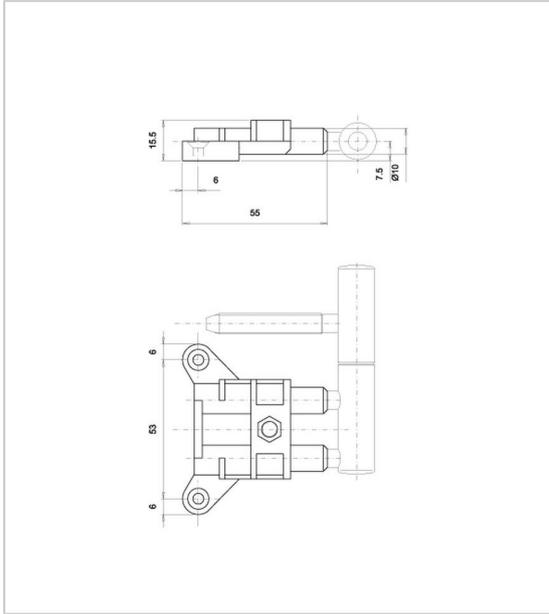
**Platine de jonction** en résine anti-corrosion pour fiche 100/101
