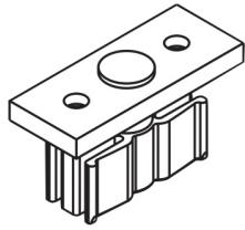
Platine de guidage avec pièce de guidage auto-serrant 14 mm.
