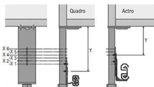
Utilisation ArciTech, hauteur 94 mm: Point de fixation X 4 - X 6 utile
