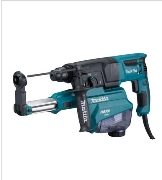
Puissant moteur de 800 W, délivre 2,2 J d'énergie d'impact pour traiter les applications les plus exigeantes. Le limiteur de couple arrête la rotation en cas de blocage pour une sécurité de l'opérateur et du moteur. 3 modes Perçage, Perforation ou Burinage pour plusieurs applications
