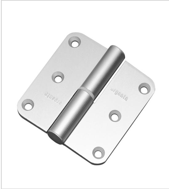
Paumelle aluminium 80/80A fermée, avec broche en acier étiré galvanisé, munie d'un fourreau en nylon de la même couleur que la paumelle.
