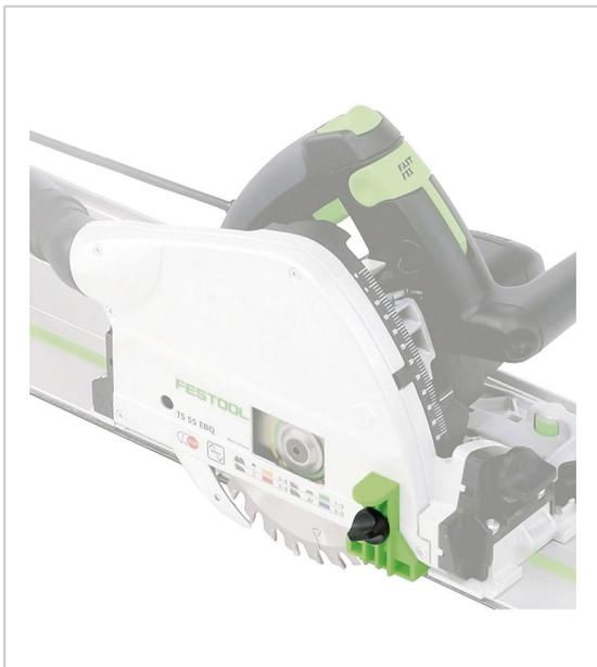
Le pare-éclats se monte à la place de la fenêtre d'inspection et réduit l'arrachement à droite de la lame de scie pendant la coupe. Une fois l'outil mis en marche, l'utilisateur entaille le pare-éclats monté pour l'adapter parfaitement à la lame de scie. Le pare-éclats peut être décalé en hauteur et convient donc à la coupe avec et sans rail de guidage. Avec marquage pour le bord avant de la lame de scie à la profondeur de sciage maximale
