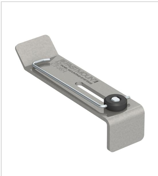
L'outil CT-05H permet de démonter les panneaux assemblés avec les clips Fasmount. Son crochet 1/4 de tour permet notamment la dépose de panneaux avec petits joints creux entre eux.
