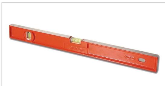
2 semelles usinées permettant de travailler avec précision corps massif en alliage d'aluminium léger et résistant fioles anti-chocs en Altuglass, incassables et réversibles fiole horizontale réglable peinture époxy résistante aux chocs et aux intempéries précision : +/- 1 mm/m.
