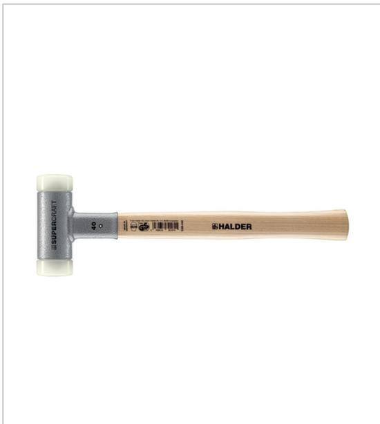
Le tube de tête des marteaux SUPERCRAFT est rempli de grenaille d'acier. Ainsi, lorsque l'embout frappe une pièce, la garniture de grenaille suit en décalé. La réduction du rebond optimise la force de frappe. Par conséquent, des frappes très puissantes sont possibles.
