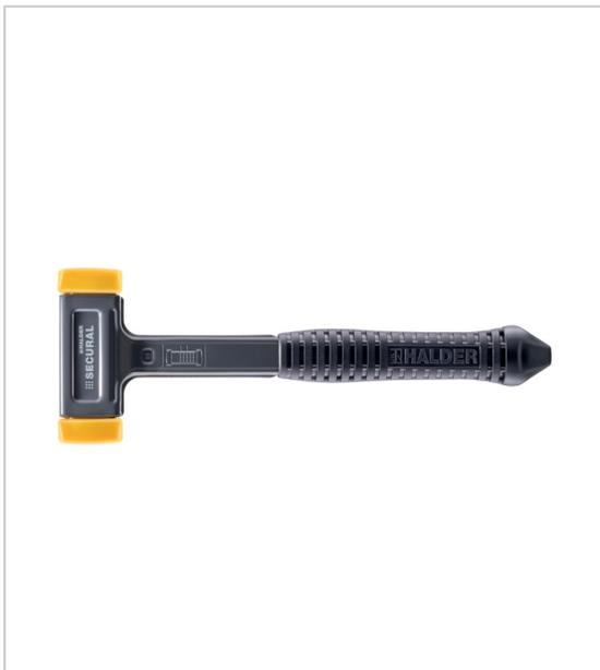
SECURAL plus est une forme élaborée du maillet SECURAL : l'extrémité de poignée spéciale convient parfaitement pour enfoncer les joints en caoutchouc. Selon la manière dont on positionne l'extrémité de la poignée, on obtient une surface étroite ou très large et on peut ainsi insérer des joints de différentes tailles.
