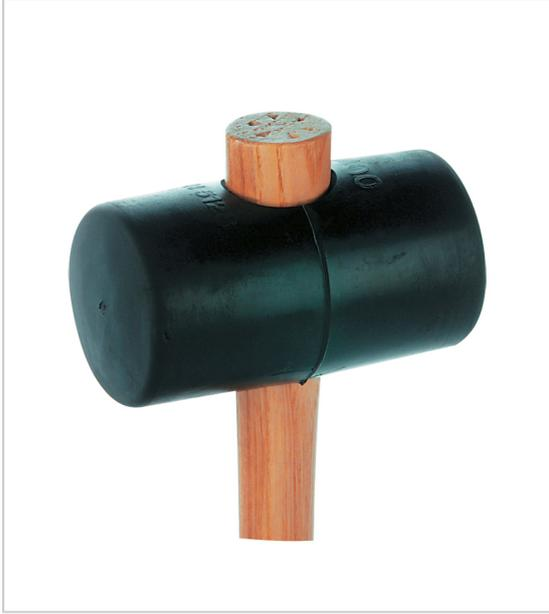
Permet de ne pas abîmer le matériau ou l'assemblage lors de la frappeusage : montage de meuble, parquet...tête en caoutchouc dure 85 +/- 5 Shore Atête légèrement bombéemanche à emmanchement conique.
