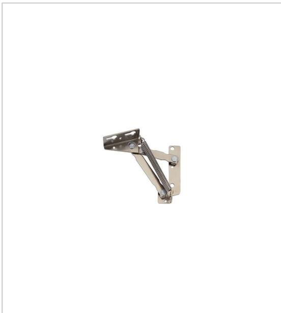
Compas de relevage Lift junior 90 Cette ferrure tres discrete et compacte ne nuit en rien au design du meuble. - Effet de ressort 90 N - Angle d'ouverture 75° - Poids maxi. de l'abattant 2 kg - Montage rationnel par fixation sur perçages en série - Compas de relevage disponible uniquement, en jeu complet comprenant une ferrure gauche et une ferrure droite.
