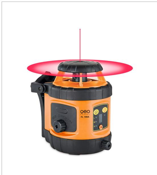
Laser automatique à l'horizontale, manuel à la verticale facile à régler grâce à une seule molette auto-nivellement très rapide 3 vitesses de rotation filetage : 5/8" précision : ±1,5 mm / 10 m autonomie : 20 h étanchéité : IP 54 poids : 1,5 kg fourni avec cellule de réception FR45, pack accu NIMH, chargeur et sacoche.
