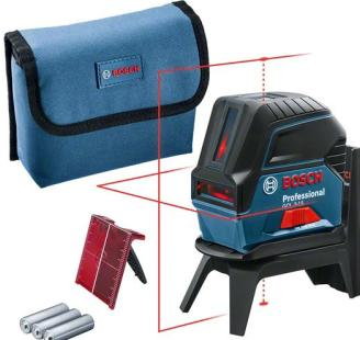
Lignes laser horizontales et verticales mise à niveau automatique jusqu'à 'b1 4° filetage du trépied: 1/4, 5/8 étanchéité à l'eau et à la poussière IP 54 classe laser 2 livré avec platine de mesure laser, housse de protection, support rotatif RM 1, 3 piles 1,5 V LR6.
