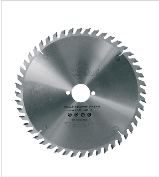
Corps en acier traité et rectifié, tensionné, nuance de carbure adaptée aux différents travaux (débit, finition, alu...) \*bois : parquet, HPL, mélaminé, MDF jusqu'à 235 mm livrées avec bagues de réduction : alésage 20 (20/16 + 20/12,7) et alésage 30 (30/16 + 30/20).
