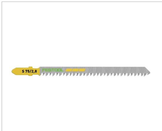
Pour PS 300, PSB 300, PS 400, PSC 400, PSBC 400, PSB 400, PS 420, PSB 420, PSC 420, PSBC 420 ; lame de scie sauteuse ultra-longue à denture japonaise extrêmement tranchante pour des coupes d'une précision exceptionnelle dans le bois
