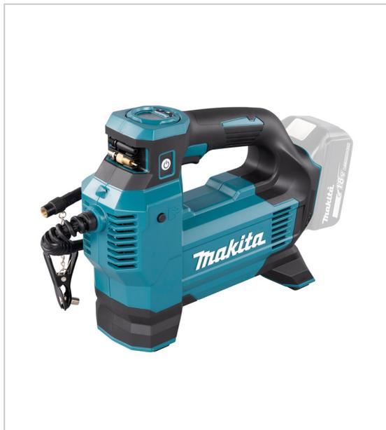
Idéal pour gonfler les pneus des voitures et des vélos, des balles de sport, ... 3 modes de gonflage (Haute vitesse, Basse vitesse ou Balle) manomètre numérique avec rétro-éclairage éclairage LED incorporé la machine s'arrête automatiquement lorsque la pression cible prédéfinie est atteinte débit à 2 bar : 22 l/min débit à 7 bar : 11 l/min livré avec 1 adaptateur Anglaise, 1 adaptateur ballon, 1 adaptateur Français, 1 adaptateur matelas sans batterie, ni chargeur.
