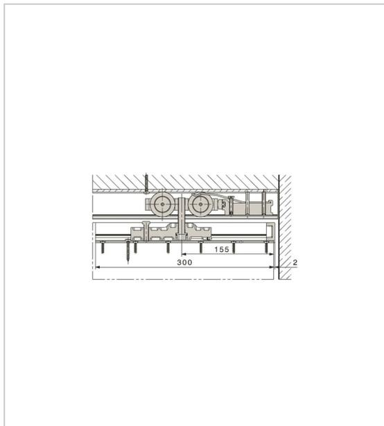
HAWA-Junior 120 B, pour portes pesant jusqu'à 120kg par vantail, est équipée de suspension à profils porteurs permettant une hauteur minimale d'installation.
