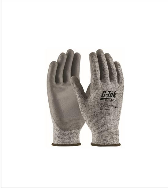
Gant tricoté sans couture en PolyKor enduction en polyuréthane sur la paume et bouts de doigts excellente dextérité, sensibilité tactile et résistance aux coupures la structure sans couture augmente le confort et la respirabilité le poignet en tricot empêche la saleté et les débris de pénétrer dans le gant pour milieux sec et légèrement humide / huileux.
