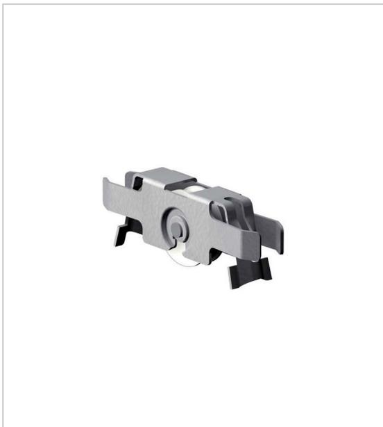
Galet sur roulement à billes recouvert de plastique, logé dans un boîtier en acier à ressort. Pour un centrage précis, une orientation automatique dans le boîtier et un silence de fonctionnement élevé.
