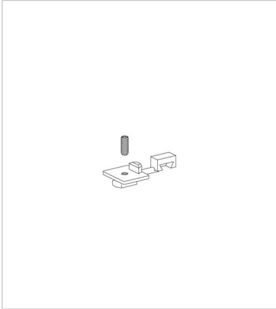
Gâche permettant le blocage des pènes des serrures 3870 (réf. 744 38700 00082) et 3871 (réf. 744 38710 00082), à l'aide de sa pièce amovible.
