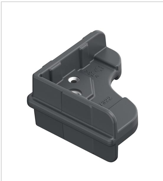
Gabarit de perçage pour paroi arrière en bois AvanTech YOU, afin de la visser directement sur l'arrière du profil tiroir (pour utilisation sans raccord arrière). Ensemble en matière plastique renforcée avec douilles de perçages en acier trempé pour mèche de 4mm et de 6mm (non fournie). Perçage pour le crochet en C avec une mèche de 6mm et bague de réglage en profondeur. (le crochet s'encastre dans le dos du tiroir).
