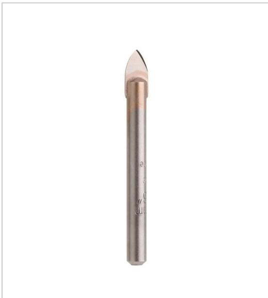
Applications : verre non trempé, faïence, porcelaine, brique, marbre hélice rapide avec un pas étroit plaquette carbure affûtage : ogive utilisation en faible vitesse de rotation avec liquide de refroidissement (eau).
