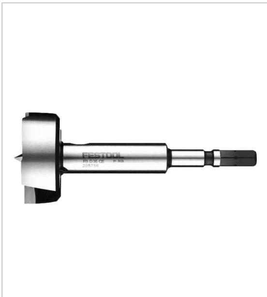
Pour les perceuses-visseuses sans fil et perceuses-visseuses à percussion sans fil Festool à raccord CENTROTEC (pour l'utilisation dans le mandrin WH-CE CENTROTEC) ; en acier pour roulement à billes de grande qualité; réaffûtable jusqu'à 5 fois
