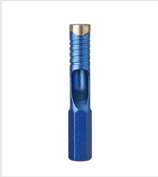
Applications : carrelage jusqu'à classe 5, marbre, terre cuite, grès céram, grès émaillé, grès, émail tête à 2 segments diamant gorge d'extraction de la carotte queue hexagonale 10 mm utilisation avec perceuse nécessitant son refroidissement (par eau).
