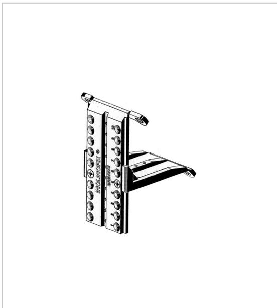
Permet la pose d'un châssis ou de rail sous pente de 17 à 63°, ainsi que la pose d'habillage.
