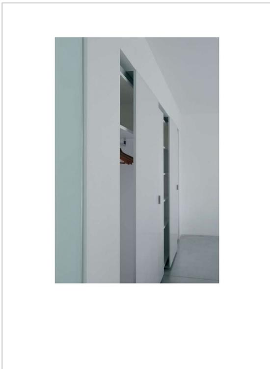
Les ferrures coplonaires permettent d'aménager des meubles, des armoires de bureau ou de dressing avec des ferrures coulissantes dont les portes en position fermée seront dans le même alignement.
