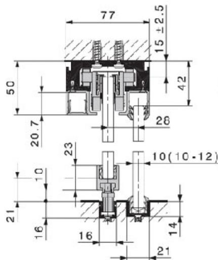
Profil de réception de verre avec guide inférieur autoserrant, guidé sur toute la longueur, et vitrage fixe dans un profil encastré dans le sol.
