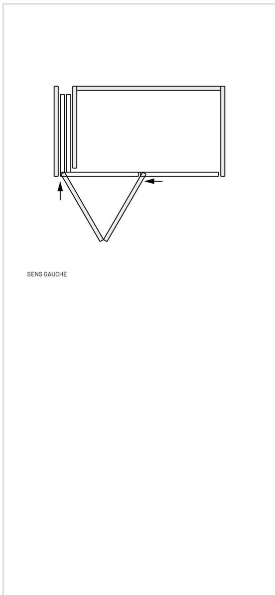
Ferrure à coulissement, repliement et escamotage latéral de portes en bois.
